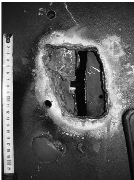
Рис. 2: Следы термической резки на корпусе банкомата.
